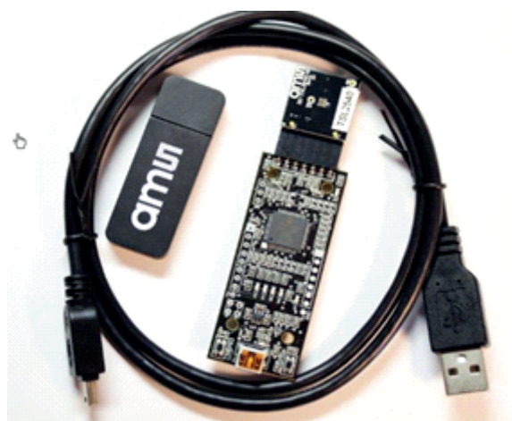
Fig. 5: Senseur de lumière ambiante Source: ams
